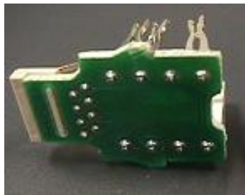
焊接的 IDC 接触点
